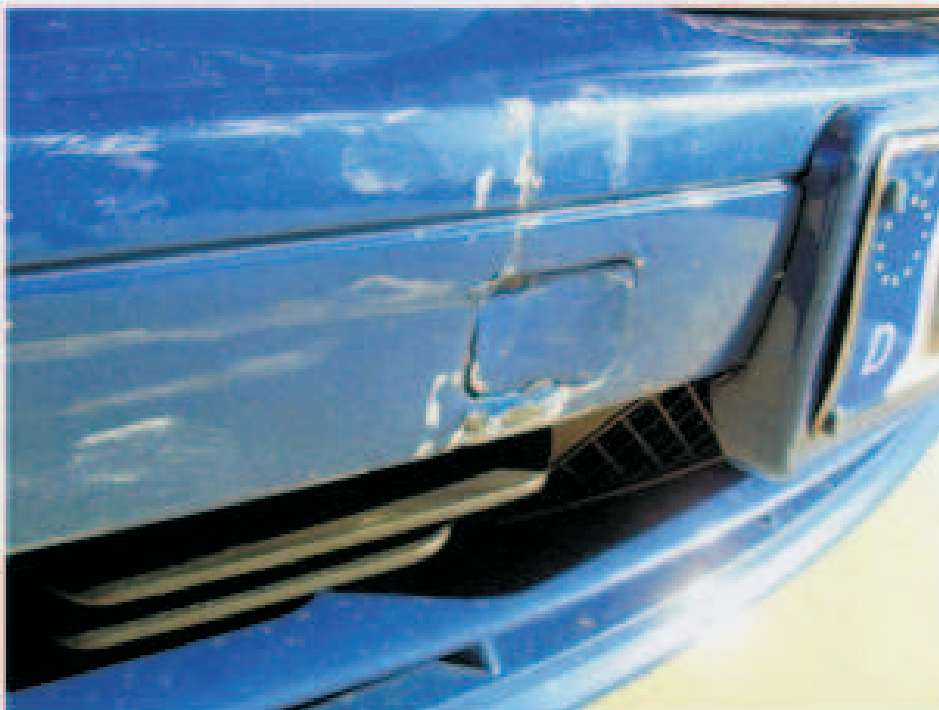
Bild 12: Stosstange vorn eingedrückt
