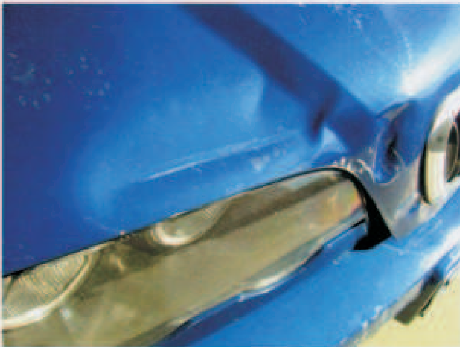
Bild 6: Motordeckel stark deformiert s.f.Fotos 1
