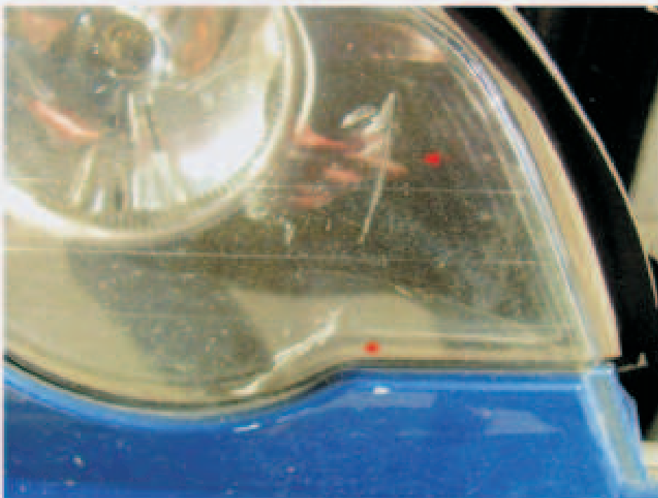
Bild 14: Anstoss an Scheinwerfer rechts
